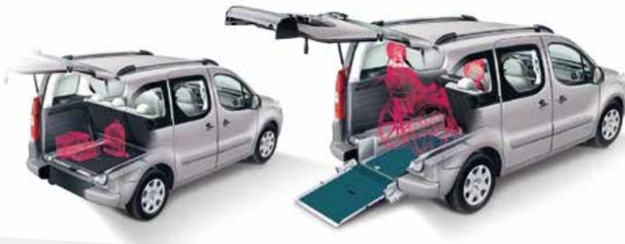
**FlexiRamp** se pliega quedando completamente plana al guardarse y no compromete el espacio interno del vehículo.
