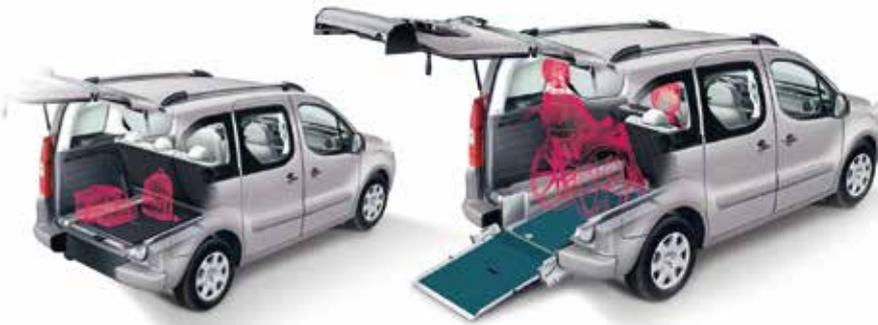
**FlexiRamp** se pliega quedando completamente plana al guardarse y no compromete el espacio interno del vehículo.
